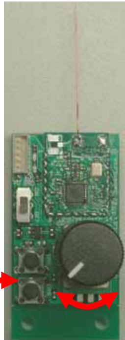
ACコントロール 送信機
